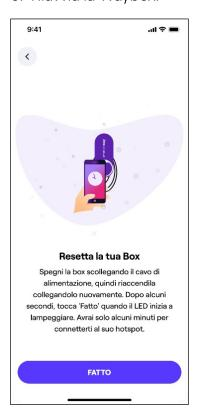
**Nota:** L'accesso all'hotspot è possibile per 2 minuti dopo l'accensione della Waybox. Se un dispositivo viene connesso all'hotspot entro due minuti, la connessione con il dispositivo rimane attiva per 10 minuti. Se la Waybox è già accesa prima di questo passaggio, scollegarla dall'alimentazione e ricollegarla nuovamente prima di procedere.
