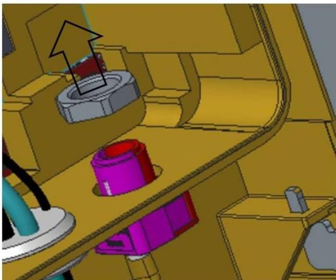
**C.** Utilizzare il foro nella parte inferiore della stazione di ricarica per sistemare il cavo del segnale.
